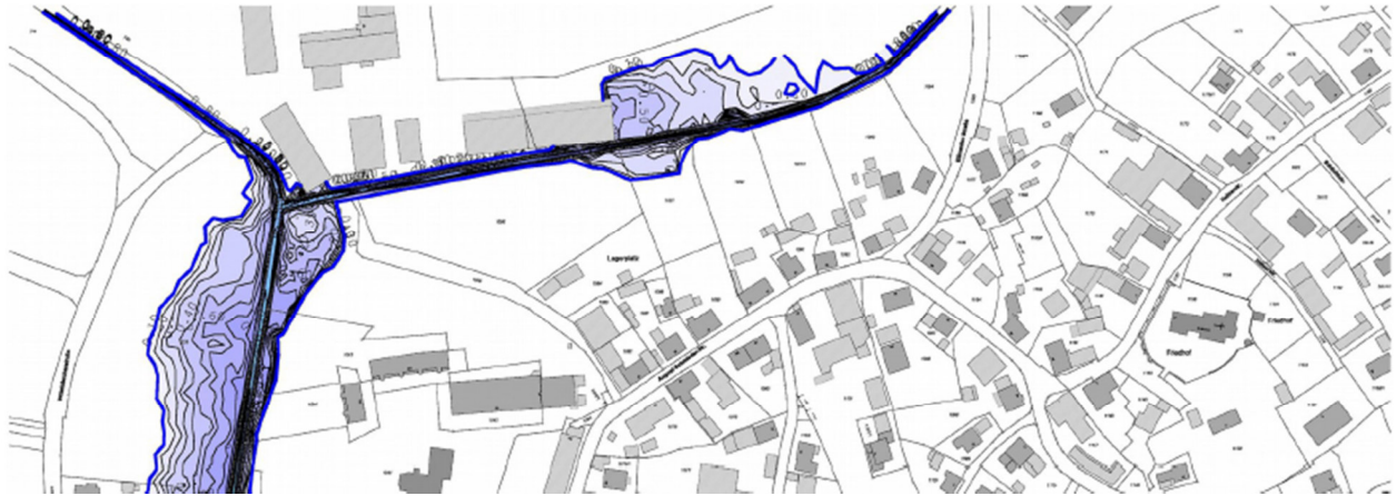
Abbildung 8: Ausschnitt aus der Abbildung 7: Fließtiefen Bestand HQ100 - ohne Maßstab aus dem integrealem Hochwasserschutz- und Rückhaltekonzept der Gemeinde Steinach (Büro Ammer, Straubing)
