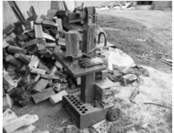
Häufig angetroffene Holzspalter mit Fußschaltung – seit vielen Jahren verboten
